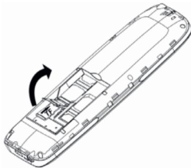
**Karty SIM** należy włożyć do odpowiednich slotów stykami w dół w taki sposób, aby styki kart SIM dotykały styków dla karty SIM w telefonie. Włóż kartę SIM 1 do prawego górnego slotu skośnym rogiem umieszczonym w prawym górnym rogu slotu, a kartę SIM 2 włóż do lewego slotu SIM skośnym rogiem umieszczonym w prawym dolnym rogu slotu.
