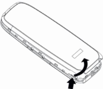
Baterii nadzvedněte nehtem nebo tupým předmětem v horní části baterie.
