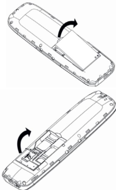
**Karty SIM** vsuňte do příslušných slotů pod baterii kontakty směrem dolů tak, aby se kontakty karet SIM dotýkaly zabudovaných kontaktů pro SIM v telefonu. Kartu SIM 1 vložte do pravého spodního slotu zkoseným rohem umístěným v levém horním rohu slotu, kartu SIM 2 vložte do levého horního SIM slotu zkoseným rohem umístěným ve spodním pravém rohu slotu.
