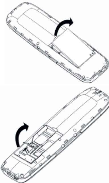
**Karty SIM** vsuňte do príslušných slotov pod batériu kontaktmi smerom dole tak, aby sa kontakty kariet SIM dotýkali zabudovaných kontaktov pre SIM v telefóne. Kartu SIM 1 vložte do pravého spodného slotu skoseným rohom umiestneným v ľavom hornom rohu slotu, kartu SIM 2 vložte do ľavého horného slotu SIM skoseným rohom umiestneným v spodnom pravom rohu slotu.
