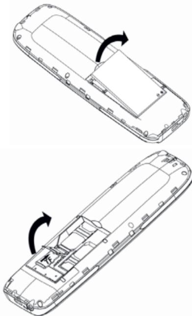
Helyezze a **SIM-kártyákat** az akkumulátor alatti megfelelő nyílásokba érintkezőkkel lefelé úgy, hogy a SIM-kártyák érintkezői hozzáérjenek a telefon beépített SIM-érintkezőihez. Helyezze be a SIM 1 kártyát a jobb alsó nyílásba úgy, hogy a levágott sarok a nyílás bal felső sarkában helyezkedjen el, helyezze be a SIM 2 kártyát a bal SIM-nyílásba úgy, hogy a levágott sarok a nyílás jobb alsó sarkában legyen.
