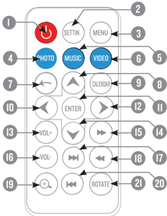
1. ON/OFF (Zapnutie/Vypnutie): zapnutie alebo vypnutie digitálneho fotorámčeka.
