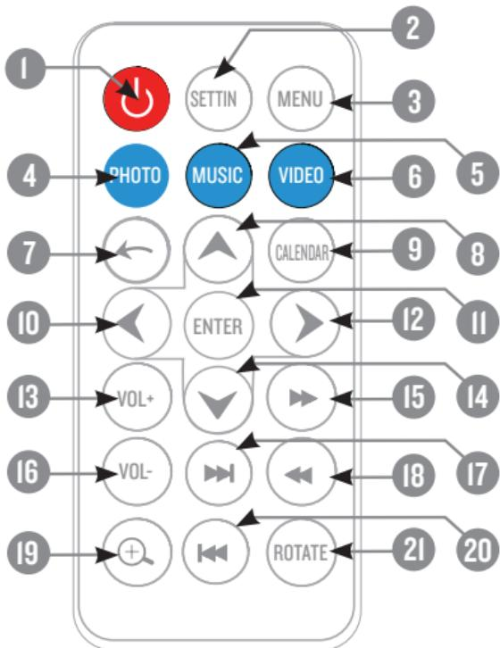
1. ON/OFF (Zapnutí/Vypnutí): zapnutí nebo vypnutí digitálního fotorámečku.
