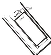
2. Do priestoru pre batérie vložte nové batérie tak, aby symbol + (plus) a - (mínus) vyznačené na dne priestoru pre batérie zodpovedali symbolom + (plus) a - (mínus) na batériach.
