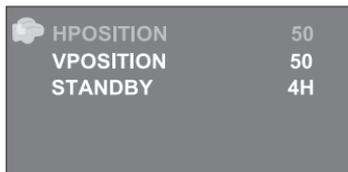
HPOSITION/VPOSITION: Nastavenie horizontálnej a vertikálnej pozície obrazovky.
