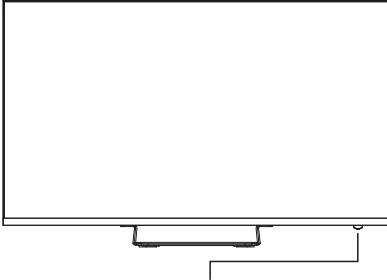
Przycisk wielofunkcyjny POWER (włączanie zasilania / funkcja przycisku) Czujnik zdalnego sterowania
