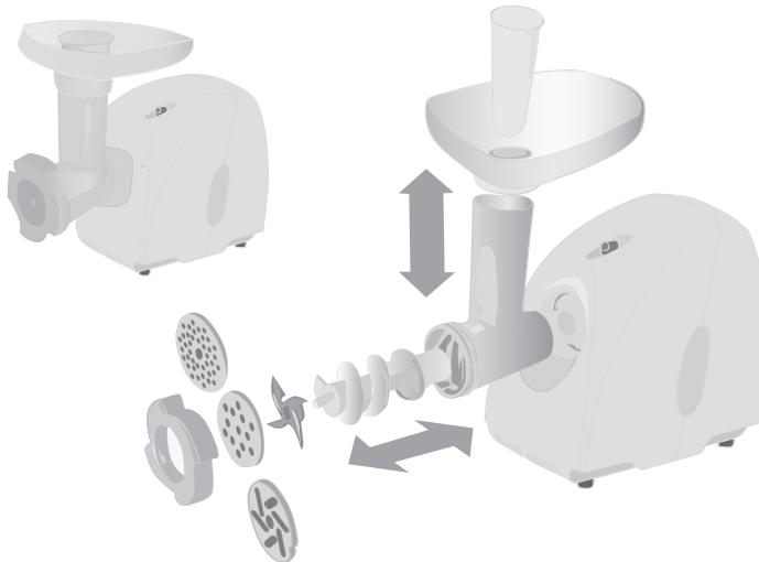
Električni stroj za mljevenje mesa sastoji se od dva osnovna dijela: jedinice motora i dodataka. Jedinica motora osigurava kretanje pužnice. Na stražnjem poklopцу motora nalazi se odjeljak za napojni kabel i odjeljak za disk za mljevenje.
