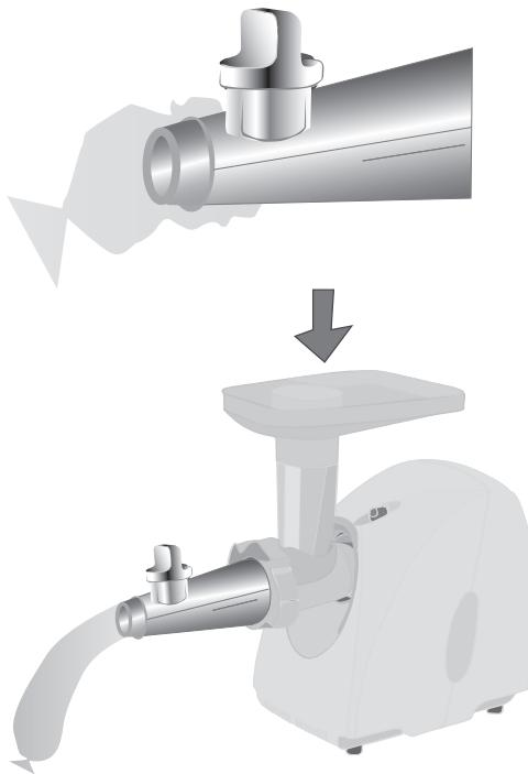
Pripremite smjesu nasjeckanog mesa. Crijeva uronite u mlaku vodu. Mokro crijevo navucite na nastavak. Napravite čvor na drugoj strani i pričvrstite ga drvenim ražnjićem. Smjesu nasjeckanog mesa postavite na pladanj. Priključite kabel napajanja u utičnicu. Prekidač postavite u položaj ON. Lagano gurnite smjesu u kanal za hranu. Količinu smjese regulirajte vijkom ②.
