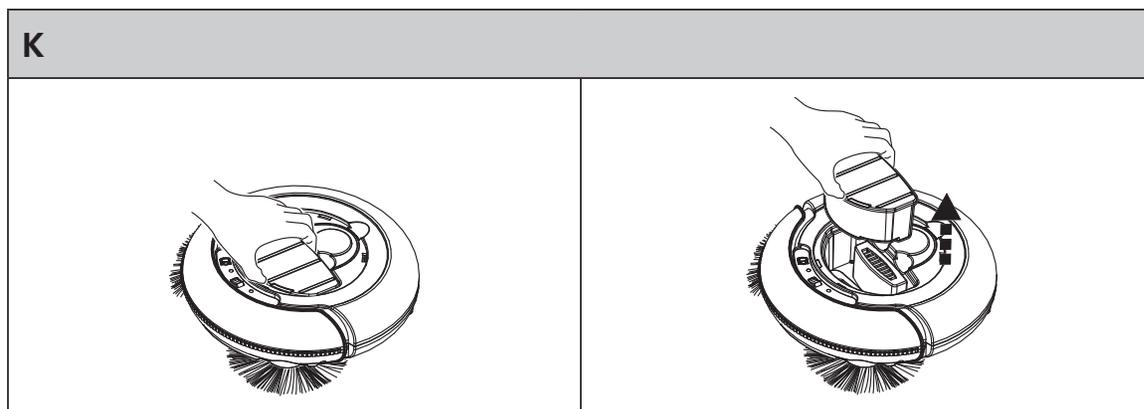
3. Skinite poklopac spremnika prašine B⑦. Izvadite filter prašine B⑧ iz spremnika prašine B⑨ i ispraznite ga.
