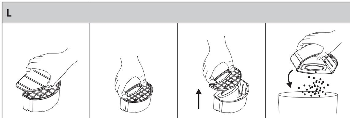
4. Operite spremnik B⑨ čistom tekućom vodom. Očistite filter prašine B⑧ mekom četkom. Ako ste oprali spremnik B⑨ u tekućoj vodi, temeljito ga posušite, i tek tada vratite filter prašine B⑧ unutra. Zatvorite poklopac spremnika B⑦. Stavite sastavljeni spremnik prašine natrag u usisavač i zatvorite gornji poklopac B⑥.
