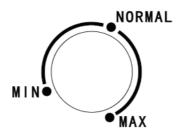
Position «Min» – cold Position «Normal» – normal freezing Position «Max» – maximum freezing
