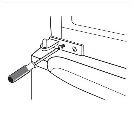
10. Znovu nasadte horné dvierka. Pred finálnym dotiahnutím horného závesu zaistite, aby boli dvierka vodorovne a zvisle vyrovnané, aby bolo tesnenie uzavreté na všetkých stranách. Potom vložte záves a priskrutkujte ho k prednej časti zariadenia.
