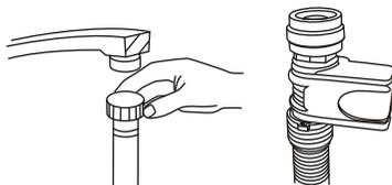
Prívodnú hadicu pripojte k prívodu studenej vody s 3/4" závitom a skontrolujte, či ste ju poriadne utiahli. Ak sú hadice nové a neboli dlhšie použité, prepláchnite ich vodou, aby ste si boli istí, že sú vnútri čisté a zbavené všetkých nečistôt. Ak toto bezpečnostné opatrenie nedodržíte, prívod vody sa môže upchať a poškodiť spotrebič.
