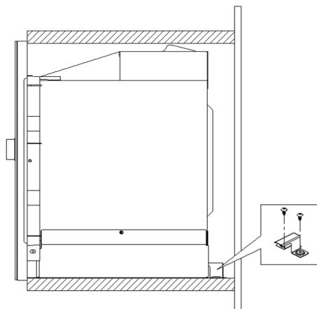
Po zajištění umístění otevřete dviřka trouby a v přední části vnitřního prostoru se nachází otvor pro zajišťovací šroub. Vložte šroub do tohoto otvoru a zašroubujte. Ujistěte se, že je správně utažen. Na šroub nasadte krytku (pokud je v příslušenství).
