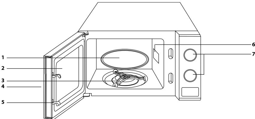
**A1** Περιστρεφόμενο πιάτο**A2** Διαφανές παράθυρο πόρτας**A3** Βάση περιστρεφόμενου δίσκου**A4** Λαβή**A5** Μηχανισμός κλειδώματος πόρτας ασφαλείας**A6** Μάγνητρον**A7** Πίνακας ελέγχου
