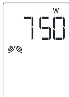
Para cocinar con potencia de microondas individualmente, pulse varias veces el botón Micro para seleccionar el nivel de potencia de cocción; a continuación, pulse el botón +/- para ajustar el tiempo de cocción deseado. El tiempo de cocción máximo es de 90 minutos.
