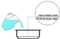
A. Coloque água até ao nível de água vapor marcado no recipiente.
