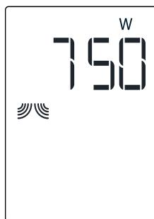
Ha egyénileg beállított mikrohullám-teljesítménnyel szeretne főzni, akkor nyomja meg többször egymás után a Micro (Mikró) gombot a főzési teljesítmény kiválasztásához, majd nyomja meg a +/- gombot a kívánt főzési idő beállításához. A leghosszabb főzési idő 90 perc.
