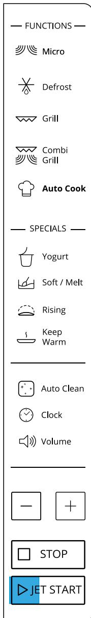
Táto funkcia umožňuje rýchle spustiť rúru. Ak tlačidlo JET START (RÝCHLY ŠTART) stlačíte raz, rúra sa automaticky spustí pri plnom výkone. Ak chcete pridať čas, počas varenia stlačte tlačidlo RÝCHLY ŠTART. Najdlhšia doba varenia trvá 90 minút.
