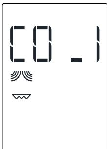
Tato funkce kombinuje zahřívání pomocí grilu a mikrovln, což vám umožňuje zkrátit dobu zapékání.
