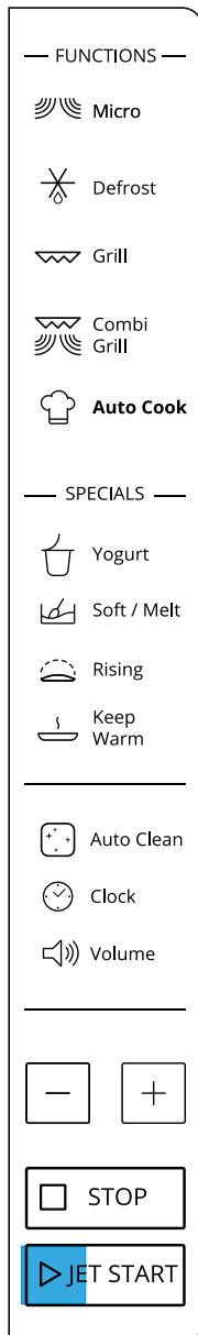
Esta función le permite iniciar el horno rápidamente. Si pulsa el botón JET START (Inicio rápido) una vez, el horno empezará a funcionar a la máxima potencia automáticamente. Durante la cocción, pulse JET START (Inicio rápido) para añadir más tiempo. El tiempo de cocción máximo es de 90 minutos.
