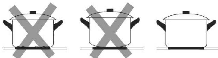
Ujistěte se, zda je dno varného nádobí hladké, sedí přesně na sklokeramické desce a má stejný průměr jako varná zóna. Používejte nádobí, jehož průměr dna je větší než zobrazena varná zóna. Použitím nádobí s o něco větším průměrem dna využijete energii s maximální účinností. Pokud použijete menší nádobí, můžete očekávat nižší účinnost. Nádobí s průměrem menším než 140 mm nemusí varná deska detektovat. Nádobí vždy vycentrujte doprostřed varné zóny.
