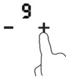
Znovu stlačte tlačidlo „+“ a na displeji sa zobrazí označenie maximálneho výkonu „b“.
