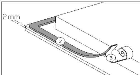
Do vyrezaného otvoru v pracovnej doske vložte varnú dosku.
