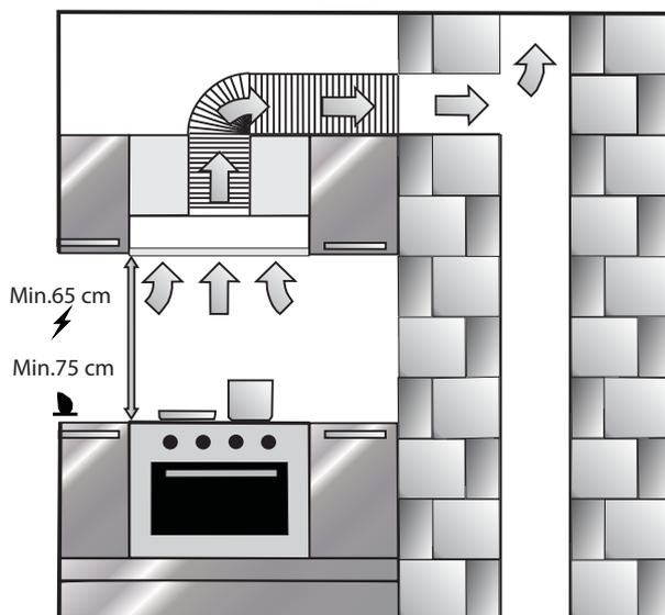
Odsavač par instalujte do výšky alespoň 65 cm od elektrické varné desky nebo do výšky 75 cm od plynové varné desky.
