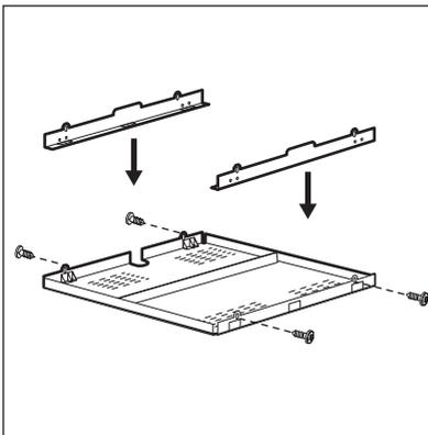
Po zamontowaniu kasey ochronnej (wyposażenie dodatkowe) nie ma konieczności montażu przegrody zabezpieczającej bezpośrednio pod płytą grzejną. Wyposażenie dodatkowe w postaci kasey ochronnej może być niedostępne w niektórych krajach. W celu uzyskania dodatkowych informacji należy skontaktować się z miejscowym dostawcą.
