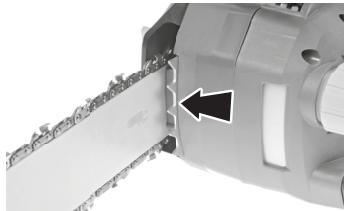
Drapáková zarážka umožňuje zaistiť pri pílení ťahom blok motoru na drevo. Sťahuje sa tým nekontrolovaný spätný úder pily.
